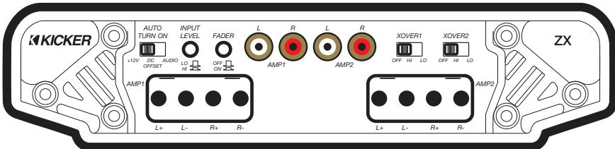
**Sélection de Mise sous Tension Automatique :** La série ZXM est dotée de trois modes différents de mise sous tension automatique pouvant être sélectionnés au panneau d'extrémité de l'amplificateur : +12V, DC Offset (décalage c.c.) et Audio. L'utilisation du mode DC Offset ou Audio permet à la borne REM d'avoir une sortie de +12 V pour des amplificateurs supplémentaires.
